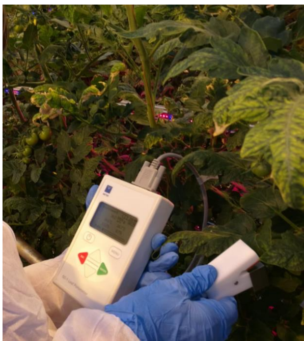
Bild 1. Mätning av stomatal konduktans. En sensor (vit i höger hand) med en slutna kammare som reagerar på fuktförändringar kläms fast på ett blad. Sensor mäter hastigheten för ångtrycksförändring i den slutna kammaren. Bild: Esa Palmujoki.
