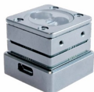
Figur 4. NIRONE sensor S (Spectral Engines). Denna model mäter på en våglängd 1100 – 2450 nm, dess vikt är 15 g. Överst är sensorn och under USB-uttag för kommunikation mellan mobiltelefon eller dator. Används bland annat inom jordbruket (sädeslag, foder och mjölkprodukter). Sensorns pris 3000 € + evaluerings kit 2000 €. https://www.spectralengines.com/products/nirone-sensors
