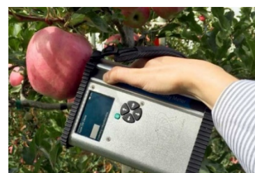
Figur 6. F-750 (Felix instrument), mäter på våglängden 310 – 1100 nm och dess vikt är 1.05 kg. Denna modell har utvecklats för att mäta torr substans, brix, syrahalt och färg. Färdiga modeller finns redan för ett flertal frukter. Pris ca 7500 €. https://felixinstruments.com/food-science-instruments/portable-nir-analyzers/f-750-produce-quality-meter/
