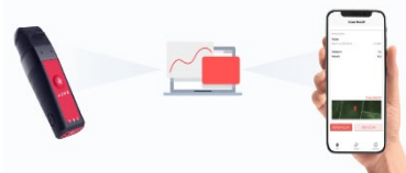
Figur 5. Hone Lab (Honeag), mäter på två våglängder 640 – 1050 nm och 1350 – 2500 nm och dess vikt är 700 g. Den har två sensorer och kommunicerar trådlöst med Android™/ iOS®. Kan användas tillsammans med Hone web platformen och dess mobila app. Med hjälp av platformen kan man göra egna modeller för det man vill mäta. Används bland annat inom jordbruket (sädeslag, foder, jord) och livsmedel (frukter, mjölk, ost). Pris ca 6000 €. (Kommer till försäljning sommar 2021.) https://www.honeag.com/hone-lab
