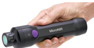
Figur 7. MicroNIR OnSite-W (VIAMI Solutions), mäter på våglängden 950 – 1650 nm och dess vikt är ca 250 g. MicroNIR pro mjukvara för PC eller tablet ingår, sensorn har USB och bluetooth. Används bland annat för livsmedel, läkemedel och inom jordbruket. Den är också kompatibel med Hone web platformen (se Figur 3). Pris ca 21 000 €. https://www.viavisolutions.com/en-us/osp/products/micronir-onsite-w#overview
