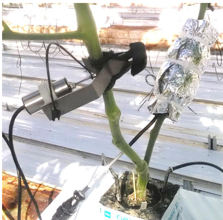
Kuva 1. Mahlavirtausanturi (oik.) ja dendrometri (vas.) asennettuna tomaatin varteen.
