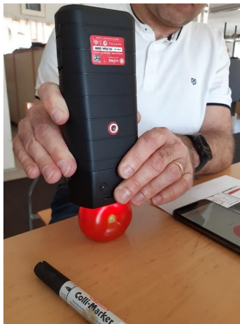
Kuva 8. Vasemmalla tomaatin valmistelua refraktometrillä tehtävää sokeripitoisuuden mittausta varten. Oikealla vastaava mittaus HoneLabin NIR-sensorilla: tomaattia ei tarvitse esikäsitellä, vaan mittaus tehdään kuoren läpi. Huomaa valo, joka tunkeutuu tomaatin sisään. Kuvat: Irene Vänninen.
