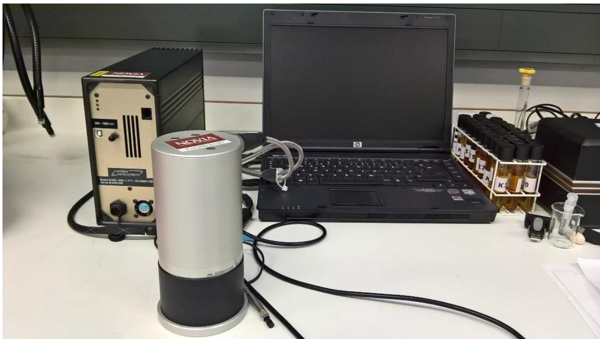
Kuva 7. Desktop-tyyppinen Sentronic-VIS-NIR-spektrometri, jolla tuotetulla datalla Noviasa laskettiin ensimmäiset kalibrointimallit tomaattien sokeripitoisuuksien mittaamiseksi.
