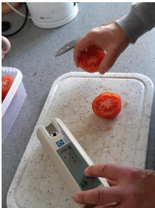
Kuva 8. Vasemmalla tomaatin valmistelua refraktometrillä tehtävää sokeripitoisuuden mittausta varten. Oikealla vastaava mittaus HoneLabin NIR-sensorilla: tomaattia ei tarvitse esikäsitellä, vaan mittaus tehdään kuoren läpi. Huomaa valo, joka tunkeutuu tomaatin sisään. Kuvat: Irene Vänninen.
