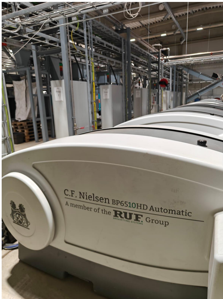
Pressar för briketteringen, totalt 9 stycken.
