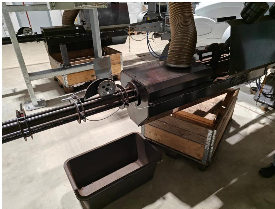
Utloppet från en press. Kugghjulet mäter längden på producerad brikett- "korv"
