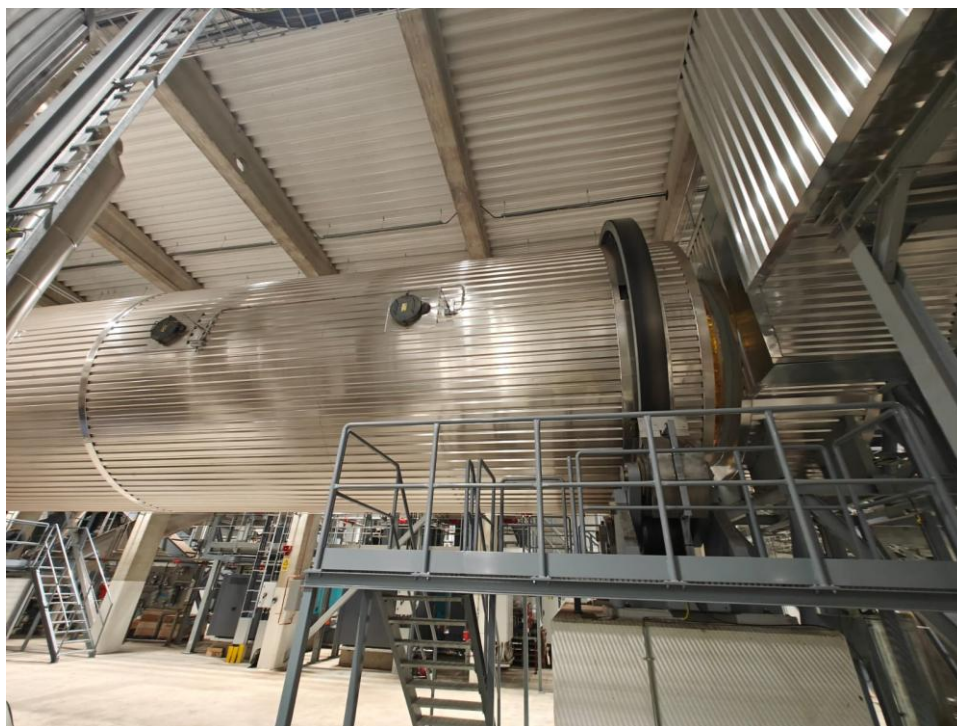
Den roterande reaktorn som är hjärtat i processen. Bränsle matas in från höger och rör sig till vänster genom trumman.
