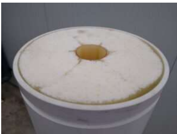
Figur 5 Så här ser membranfiltret ut ovanifrån
