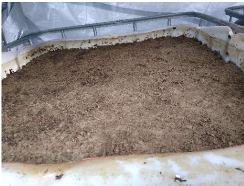
Figur 12 Filtret efter att ytan skalats bort.
