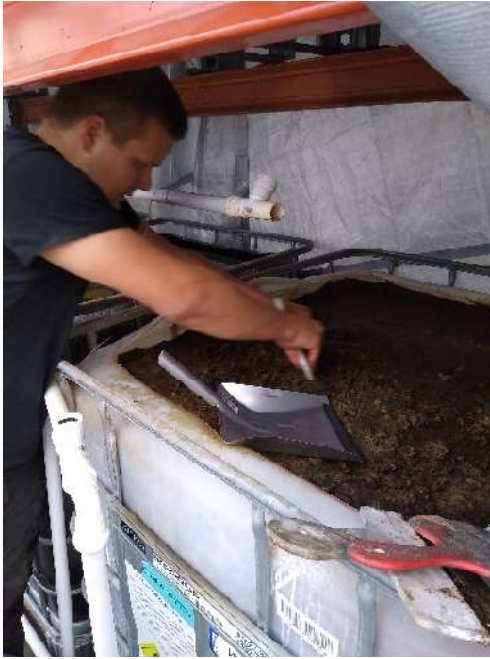
Figur 10 För att skrapa bort filteryta användes verktygen som ses på bilden
