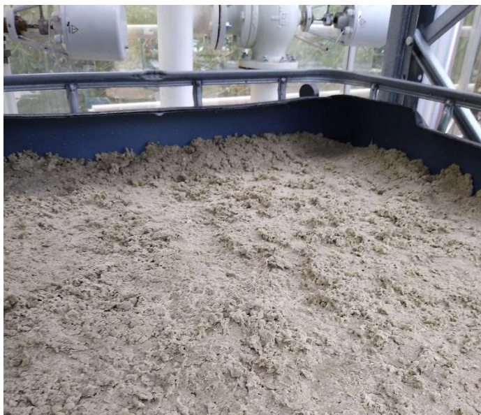
Figur 3 Stenullen stampades så att den blev mycket tätt packad.
