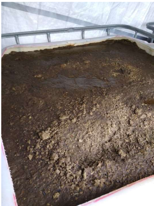
Figur 9 Filtret innan ytan skalades bort.
